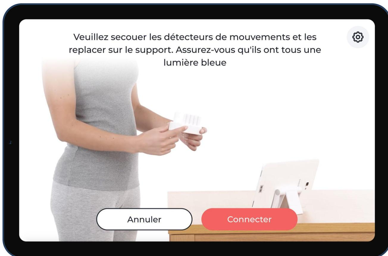
**Action :** Vous devrez secouer les capteurs de mouvements pour qu'ils affichent un voyant bleu et puissent lancer la connexion à la tablette. Si les capteurs affichent un voyant rouge ou jaune, veuillez les recharger avant de les utiliser.
